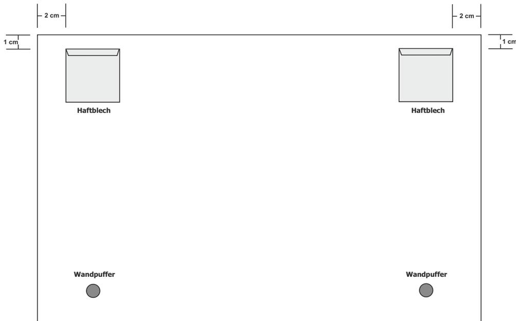
**2.** Reinigen Sie die zu beklebende Fläche mit einem sauberen Tuch unter Verwendung von materialverträglichen Lösemitteln, wie Benzine, Isopropanol (Alkohol), Ester oder Ketone und fassen Sie danach die gereinigte Fläche nicht mit den Fingern an. Wenn keine Restfeuchtigkeit vom Reiniger mehr vorhanden ist, können Sie die Haftbleche auf die Platte kleben.
